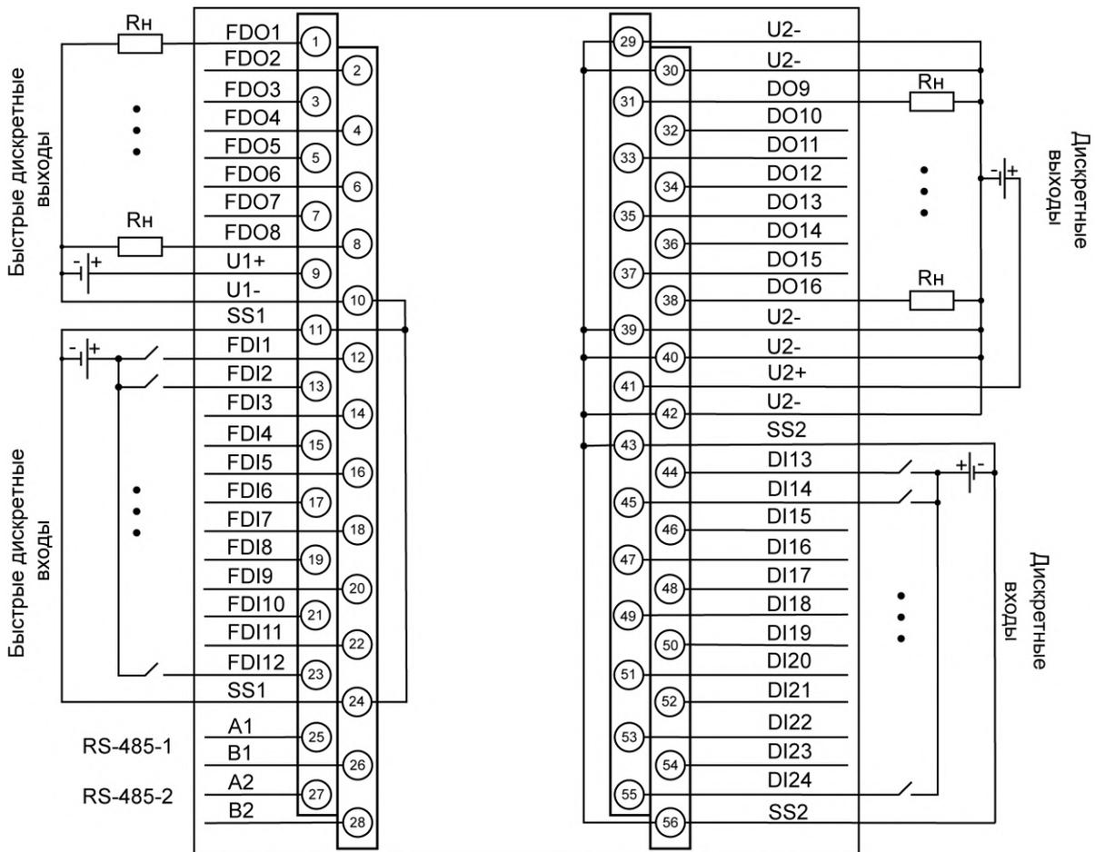
Рисунок 5.4 – Назначение контактов клеммника (модификация 03)
