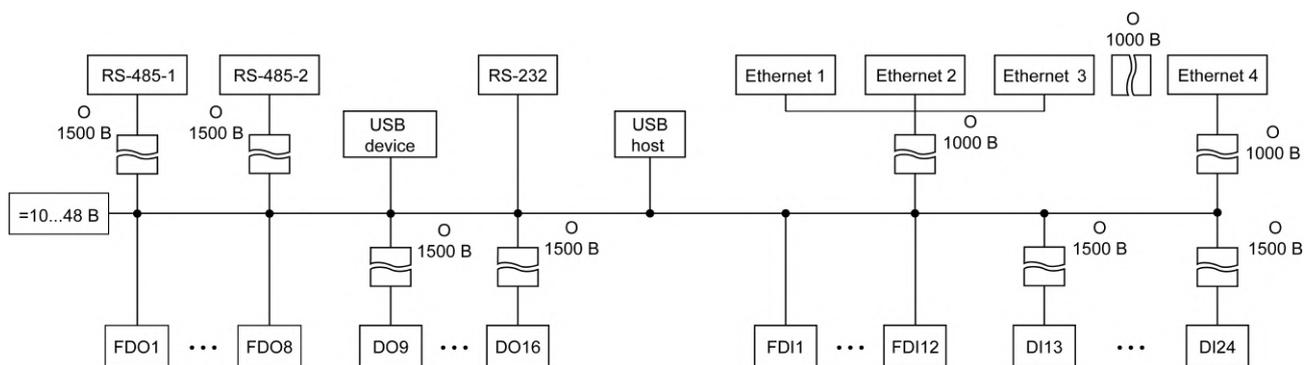
Рисунок 2.3 – Схема электрической прочности изоляции ПЛК210-03
