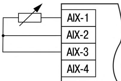
Рисунок 5.24 – Схема подключения датчиков типа 0...2 кОм и 0...5 кОм
