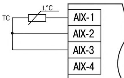
**Рисунок 5.19 – Схема подключения ТС по трехпроводной схеме**
