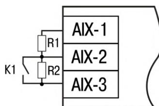
Рисунок 5.25 – Схема подключения датчика типа «сухой контакт»
