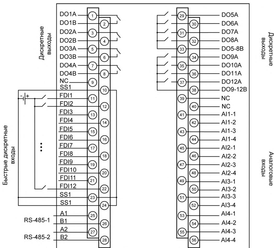
Рисунок 5.5 – Назначение контактов клеммника (модификация 04)
