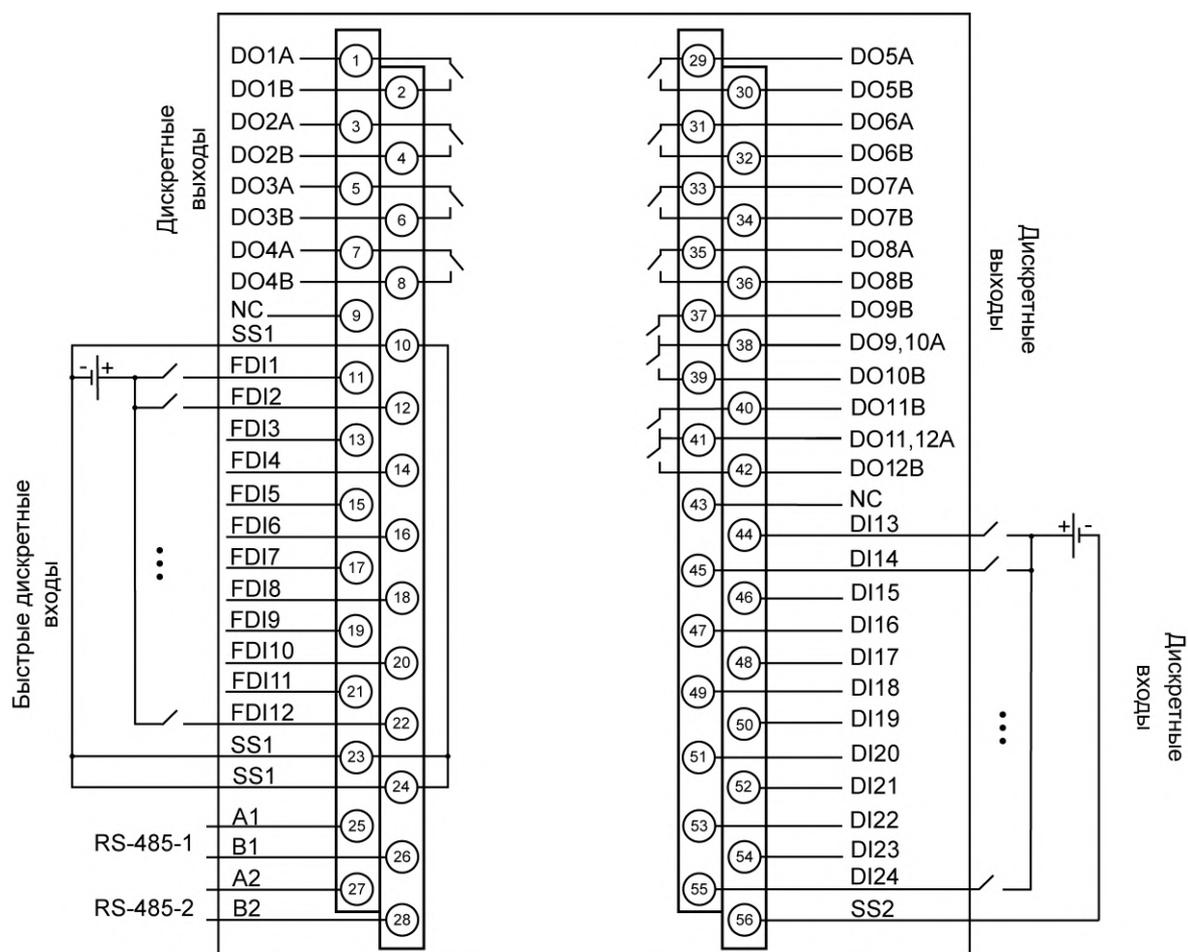
Рисунок 5.3 – Назначение контактов клеммника (модификация 02)
