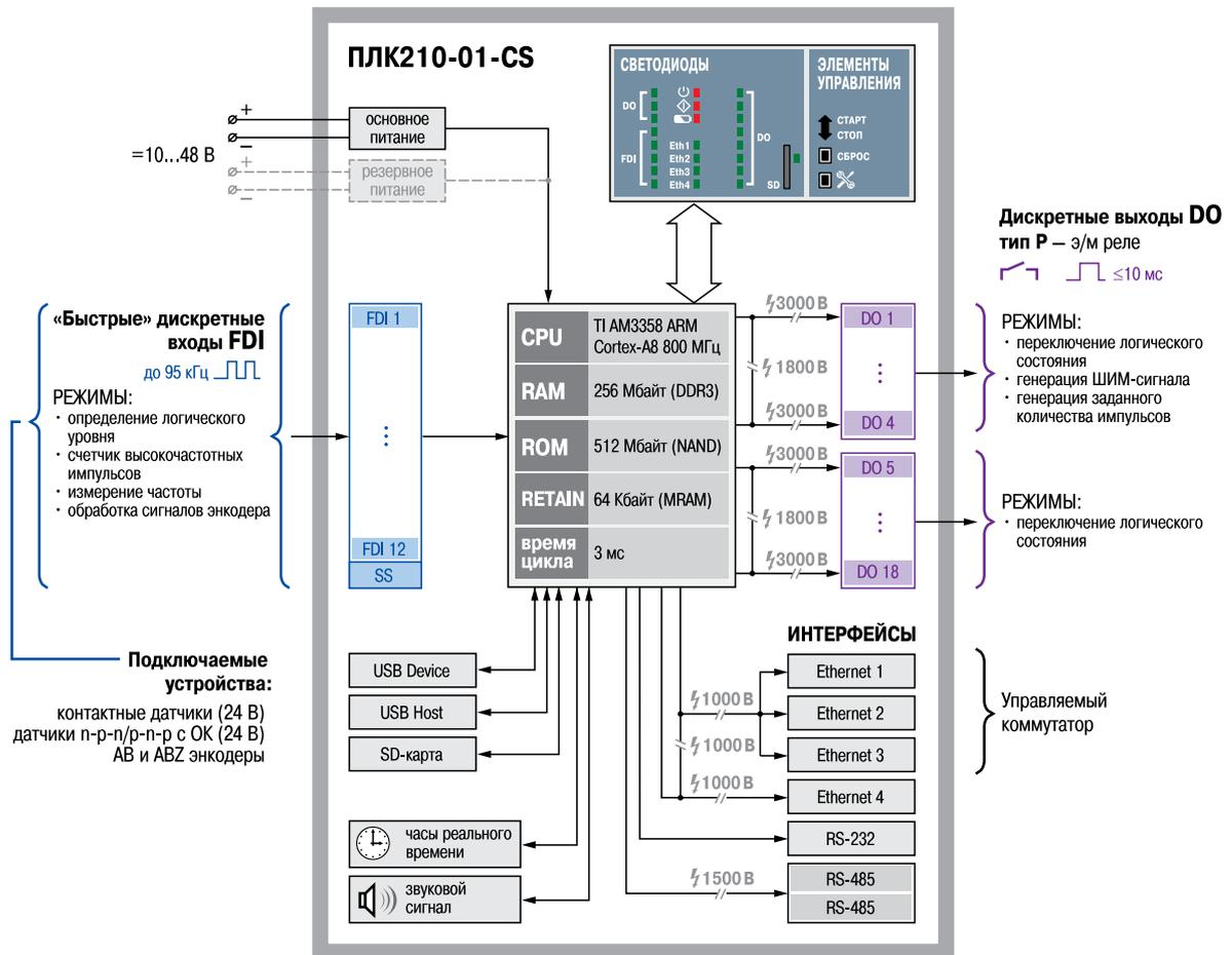
Рисунок 3.1 – Функциональная схема ПЛК210-01-CS
