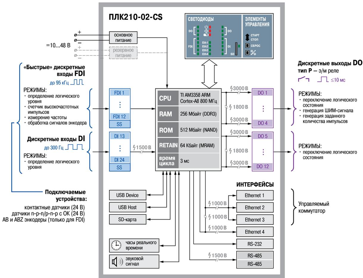
Рисунок 3.2 – Функциональная схема ПЛК210-02-CS
