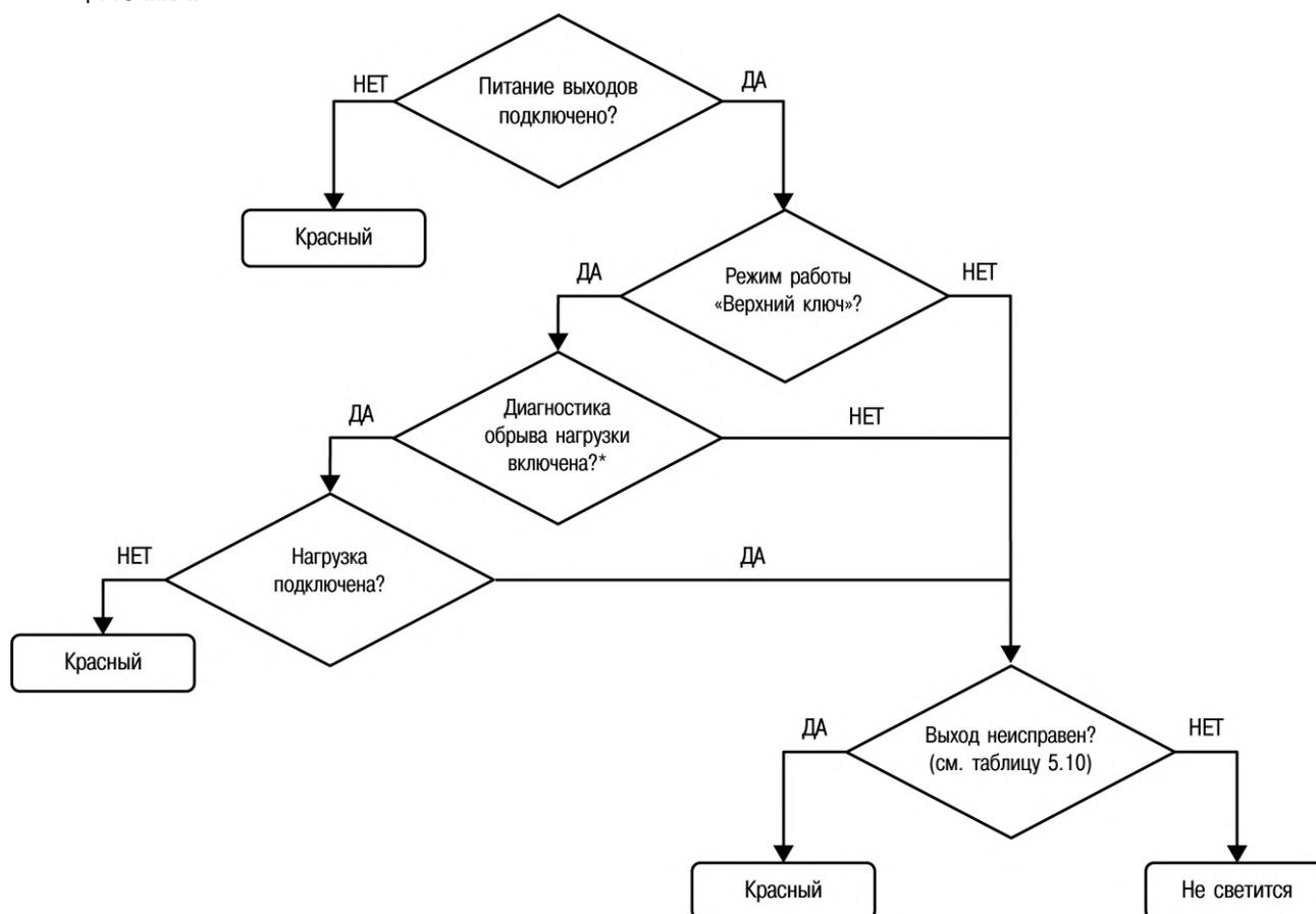
Рисунок 5.18 – Схема для определения цвета индикатора транзисторных выходов
