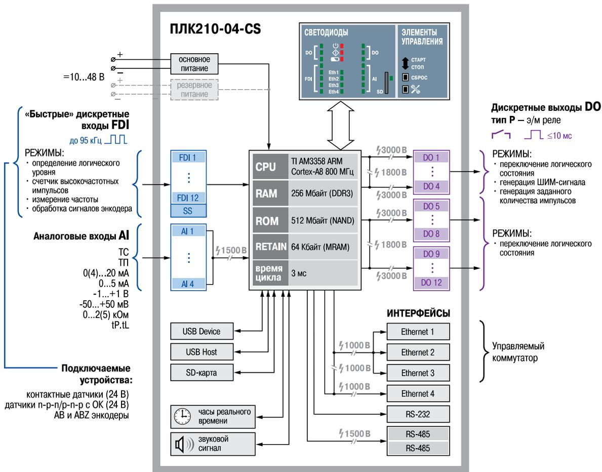
Рисунок 3.4 – Функциональная схема ПЛК210-04-CS
