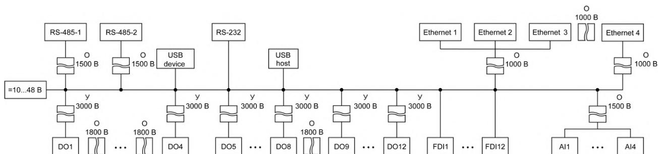
Рисунок 2.4 – Схема электрической прочности изоляции ПЛК210-04
