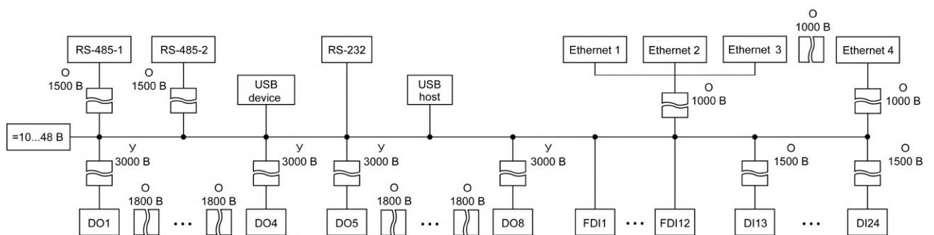
**Рисунок 2.2 – Схема электрической прочности изоляции ПЛК210-02**
