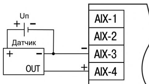
Рисунок 5.23 – Схема подключения датчиков с унифицированным выходным сигналом 0...20 мА и 0...5 мА по трехпроводной схеме
