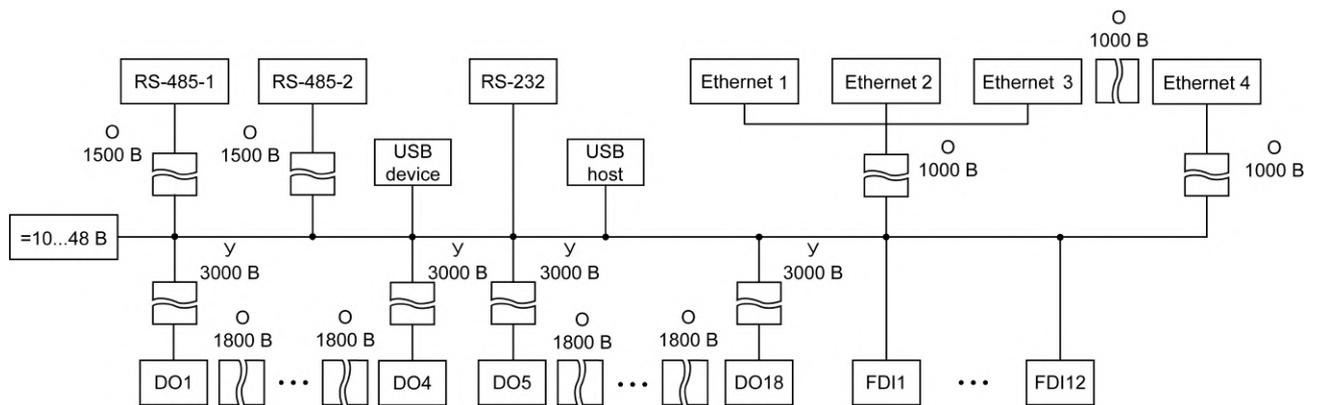
**Рисунок 2.1 – Схема электрической прочности изоляции ПЛК210-01**
