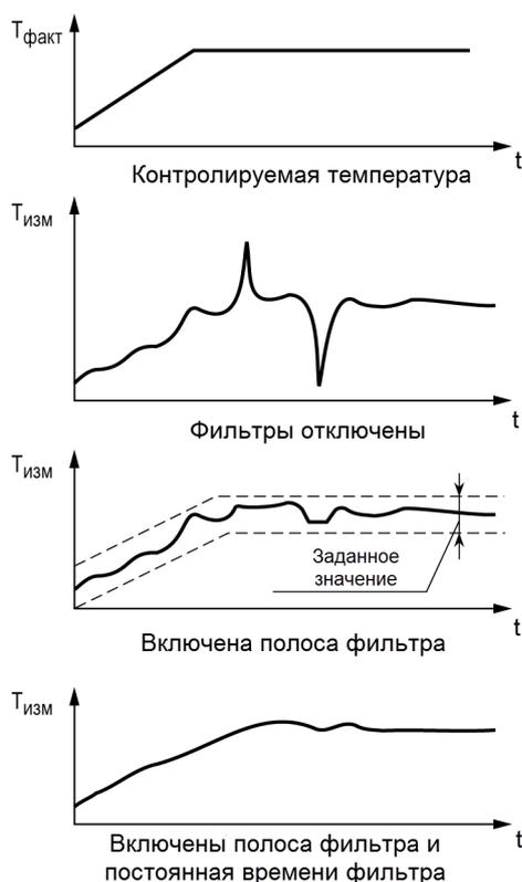
Рисунок 5.26 – Временные диаграммы работы цифровых фильтров
